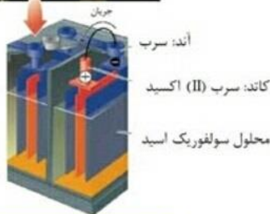
شکل ۴. باتری خودرو، نمونه ای از سلول های الکتروشیمیایی
