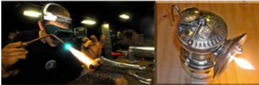
شکل ۷. استفاده از گاز اتیلن (استیلن) در برشکاری فلزات و لامپ های کاربرد.
