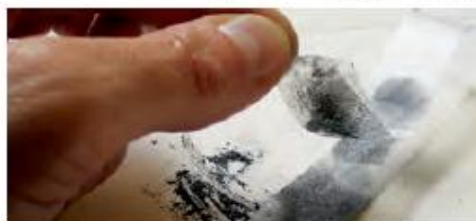
شکل ۴- تهیه گرافن با استفاده از نوار چسب
