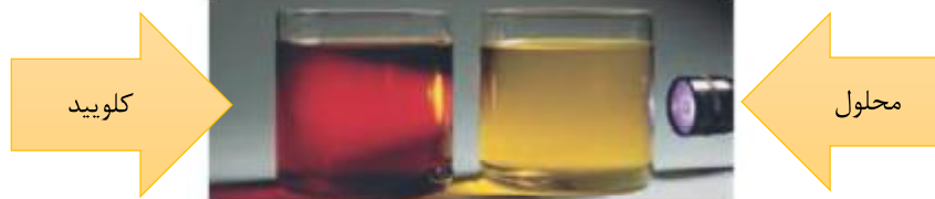
شکل ۲- مقایسه رفتار نور در یک محلول و کلوئید. ذره های موجود در کلوئید درشت تر از محلول اند و به همین دلیل نور را پخش می کنند.
