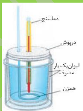
شکل ۸- ساختار گرماسنج لیوانی
