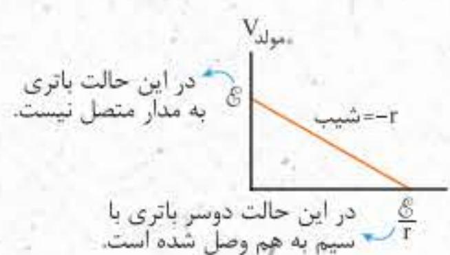
$$V_{\text{مولد}} = \mathcal{E} - rI \quad \text{نامودار} \leftarrow \text{ولتاژ سرباتری} \leftarrow$$
