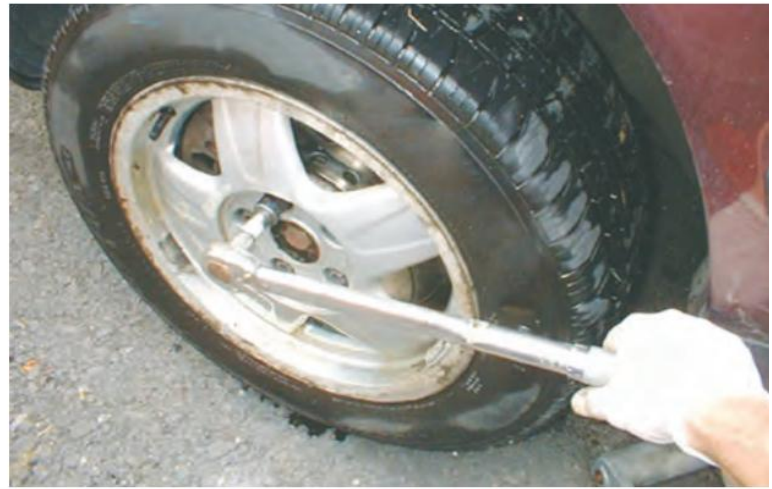
شکل ۶- با وارد کردن نیرو به دسته آچار، پیچ می‌چرخد.
