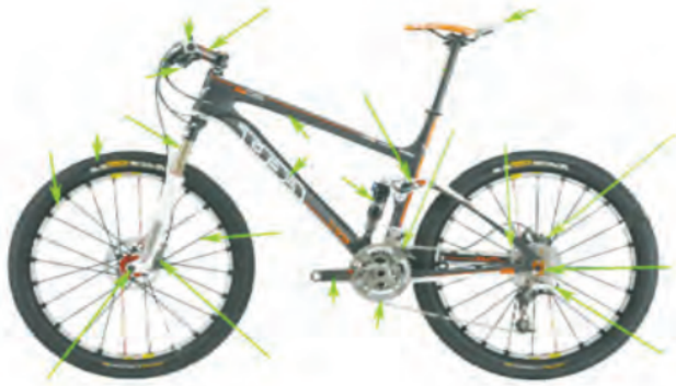
شکل ۳ - دوچرخه از اجزا یا ماشین های ساده تری مانند : اهرم، پیچ و مهره، چرخ و محور، چرخ و دنده و ... تشکیل شده است.
