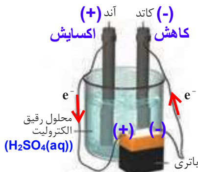
شکل ۱۱- تجزیه آب به عنصرهای سازنده آن با مصرف انرژی الکتریکی
